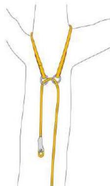
Fig. 8 - Ancoraggio passante per corda raddoppiata
